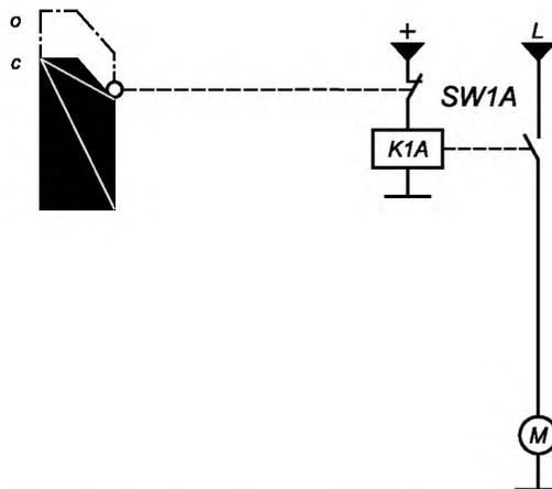
o — разомкнуто; c — замкнуто; M — двигатель; K1A — контактор;
