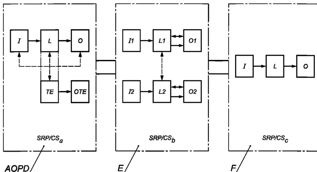
AOPD — активное оптоэлектронное защитное устройство (например, световой барьер); E — электронная логическая схема управления; F — гидрораспределитель; I, I1, I2 — входные устройства, например, датчик; L, L1, L2 — логические блоки; O, O1, O2, OTE — выходные устройства, например, главный контактор; TE — испытательное оборудование
