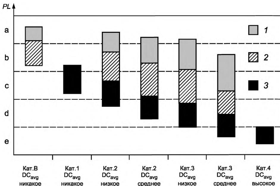
$PL$  — уровень эффективности защиты; 1 —  $MTTF_d$  каждого канала — низкое; 2 —  $MTTF_d$  каждого канала — среднее; 3 —  $MTTF_d$  каждого канала — высокое
