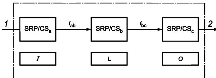
$I$  — ввод;  $L$  — логический элемент;  $O$  — вывод; 1 — событие инициации (например, ручная активация нажимной кнопки, открытие предохранительного приспособления, прерывание пучка AOPD); 2 — силовой привод механизма (например, тормоз двигателя)
