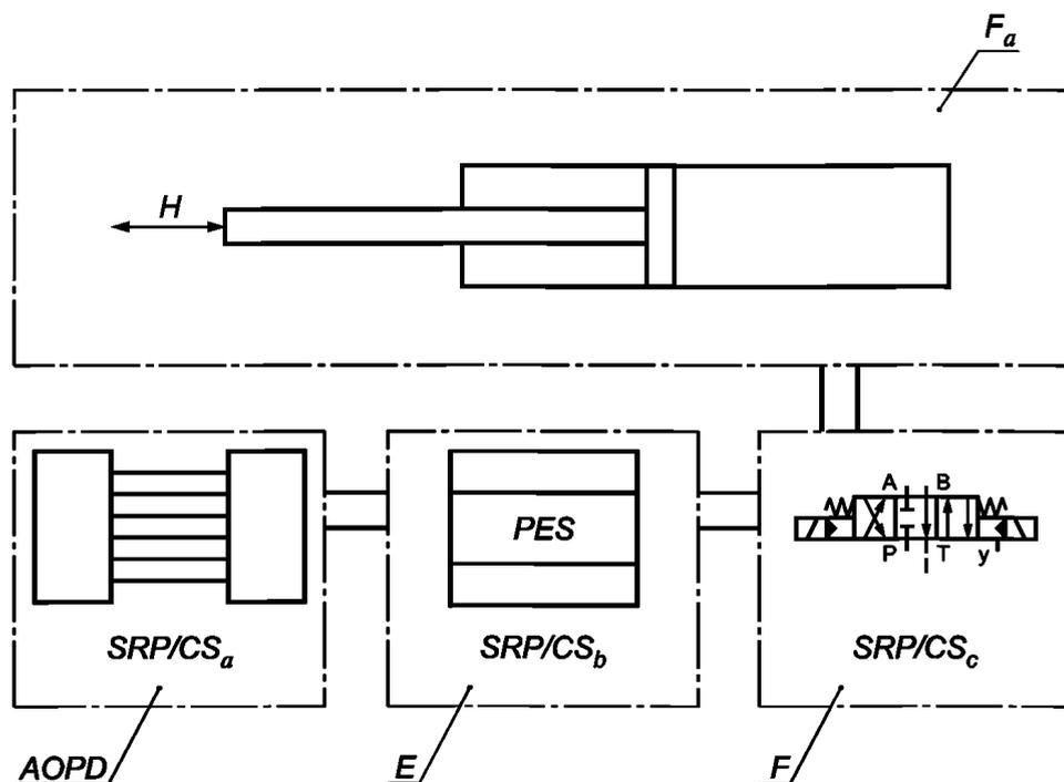
AOPD — активное оптоэлектронное защитное устройство (например, световой барьер), SRP/CS<sub>a</sub>: категория 2 [тип 2], PL = c; E — электронная логическая схема управления, SRP/CS<sub>b</sub>: категория 3, PL = d; F — гидрораспределитель, SRP/CS<sub>c</sub>: категория 1, PL = c; F<sub>a</sub> — гидроцилиндр; H — опасное перемещение
