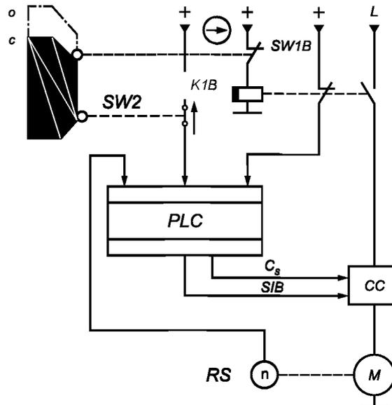
*PLC* — программируемый логический контроллер; *CC* — преобразователь тока;
