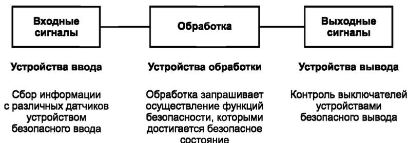
Рисунок 7 — Общая архитектурная модель программного обеспечения
