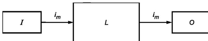
$i_m$  — средства связи;  $I$  — входное устройство, например, датчик;  $L$  — логический блок;
