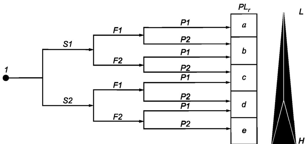
1 — начальная точка оценки риска для элемента системы управления, связанного с обеспечением безопасности; L — низкий вклад в снижение рисков; H — высокий вклад в снижение рисков;  $PL_r$  — требуемый уровень эффективности защиты
