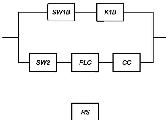
*SW1B* и *K1B* составляют первый канал, *SW2*, *PLC* и *CC* составляют второй канал; *RS* используется только для тестирования преобразователя тока.
