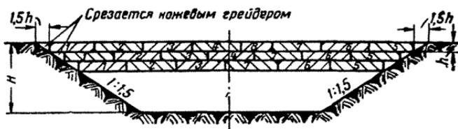
Рис. 85. Последовательность разработки скреперами слоев грунта в выемке
