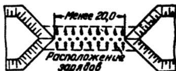
Рис. 94. Схема расположения скважинных зарядов для образования осевой траншеи
