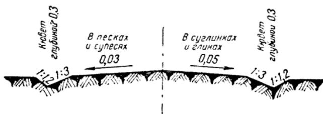
Рис. 58. Поперечный профиль грунтовой профилированной дороги
