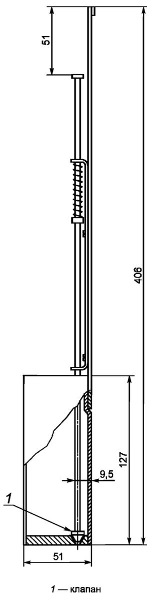
Рисунок 2 — Поверхностный пробоотборник
