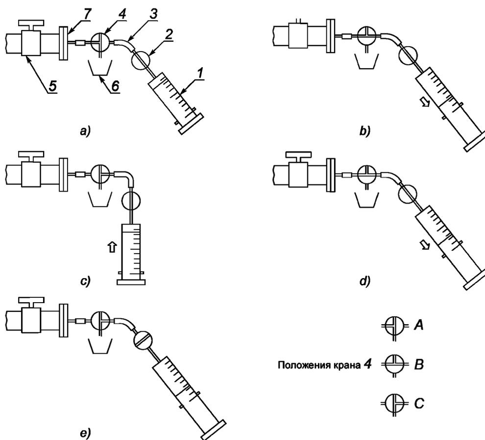
a — промывание; b — смазывание и промывание шприца; c — опорожнение шприца; d — отбор пробы; e — отсоединение шприца; 1 — шприц; 2 — запорный кран; 3 — гибкая соединительная трубка; 4 — трехходовый кран; 5 — пробоотборный кран оборудования; 6 — емкость для отходов; 7 — глухой фланец
