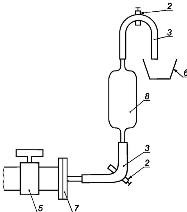
2 — запорный кран (внутренний, внешний); 3 — гибкая соединительная трубка; 5 — пробоотборный кран оборудования;
