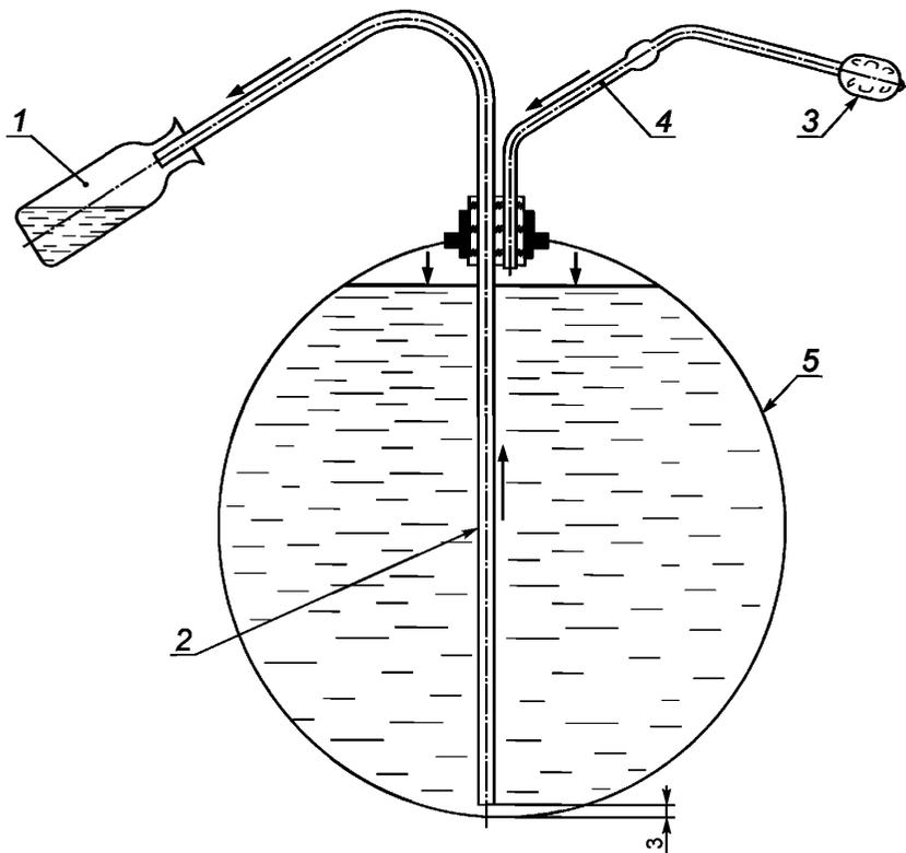
1 — бутылка для пробы; 2 — стеклянная трубка внутренним диаметром 13 мм; 3 — нагнетатель воздуха;
