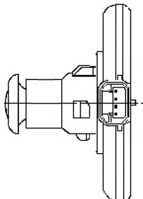
Рисунок 4 — Пример заменяемого светодиодного источника света
