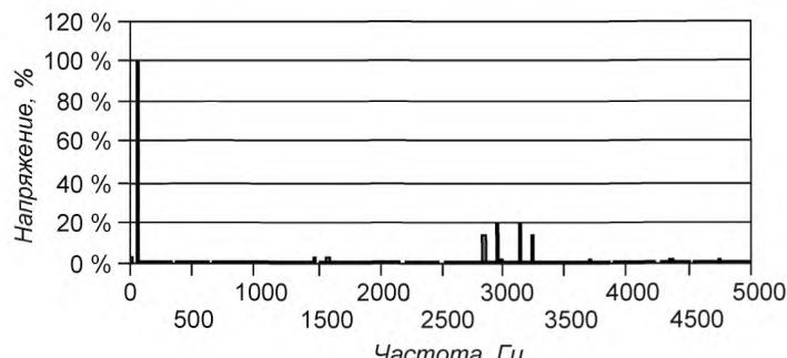
Спектр частот напряжения на выходе преобразователя — инвертора напряжения типа А,  $f_1 = 50$  Гц,  $f_s = 3$  кГц
