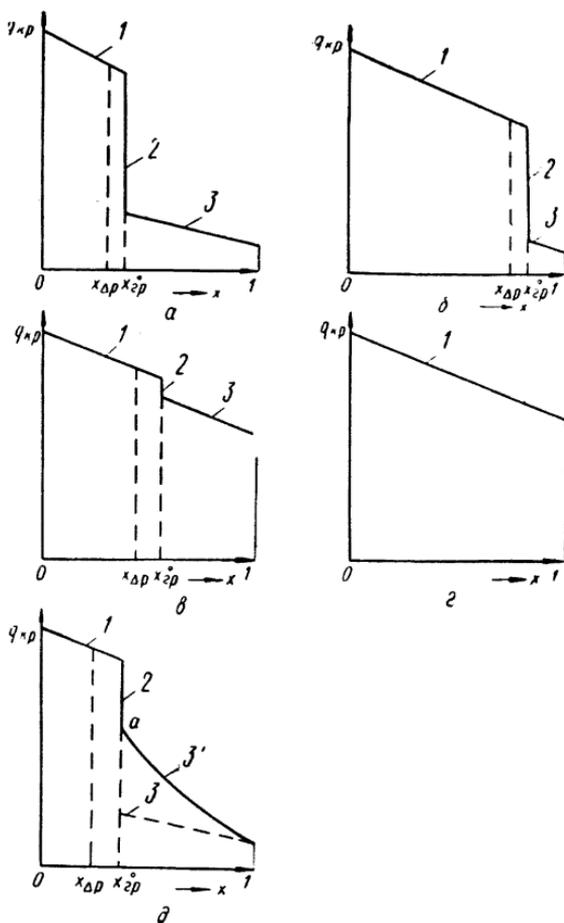
1 — кризис I рода; 2 — кризис II рода без орошения при  $x_{вх} > x_{\Delta p}$ ; 3 — кризис II рода без орошения при  $x_{вх} > x_{\Delta p}$ ; 3' — кризис II рода при наличии орошения; а — точка начала орошения
