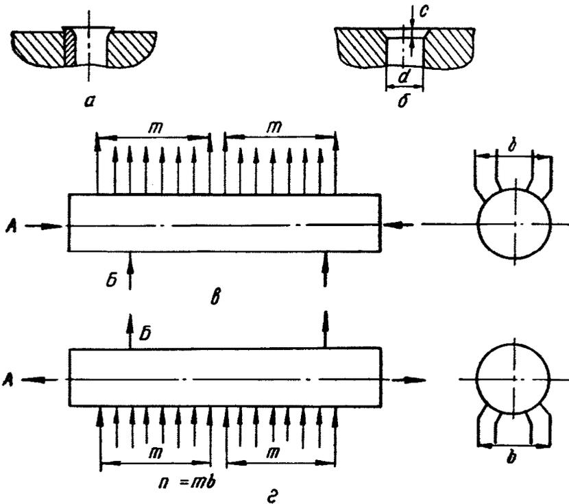
*a* — вход в трубу с вальцованным колокольчиком; *б* — конический вход в трубу; *в* — раздающий коллектор с торцевым (*A*) или угловым (*B*) подводом или отводом; *г* — собирающий коллектор с рассредоточенным подводом и торцевым или угловым отводом, *m* — число поперечных рядов подводящих (отводящих) труб вдоль коллектора, приходящееся на одну отводящую (подводящую) трубу; *b* — число труб в поперечном ряду
