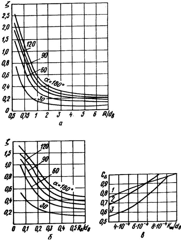
$a$  — гибы при  $k_{ш}/d_B > 8 \cdot 10^{-4}$ ;  $б$  — колено при  $k_{ш}/d_B > 8 \cdot 10^{-4}$ ;  $в$  — поправка на шероховатость, меньшую чем  $8 \cdot 10^{-4}$
