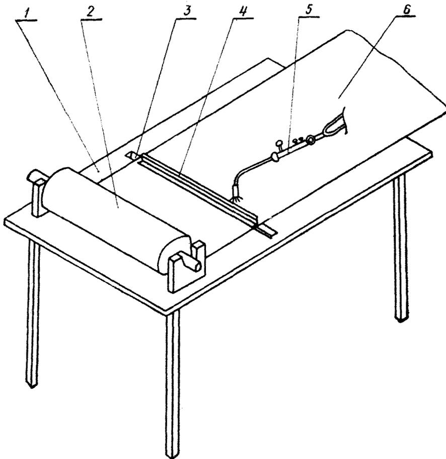
1 — стол; 2 — рулон стеклоткани; 3 — прорезь в столе; 4 — направляющая рейка; 5 — горелка газовая; 6 — отрезанная стеклоткань
