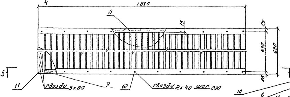
Спецификация древесины на водочувствительные решетки ВР-1, ВР-2
