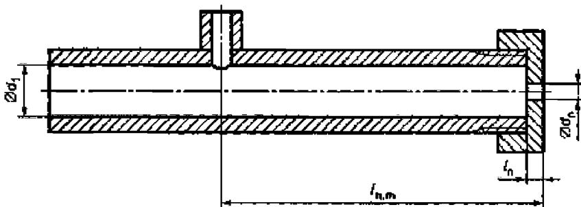
$d_n$  — диаметр отверстия сопла, равный  $(4 \pm 0,1)$  мм;  $l_n$  — длина отверстия сопла, равная  $(4 \pm 0,1)$  мм;  $d_1$  — внутренний диаметр трубы, равный  $(12,5 \pm 1)$  мм;  $l_{n,m}$  — расстояние между отверстием сопла и манометром, равное  $(80 \pm 1)$  мм
