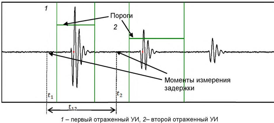
Рисунок 1 – Осциллограмма УИ
