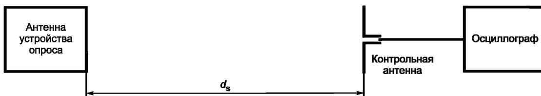
Рисунок 1 — Установка для испытаний модуляции устройства опроса
