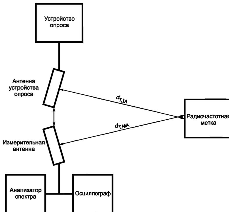
Рисунок 3 — Установка для испытаний демодуляции радиочастотной метки
