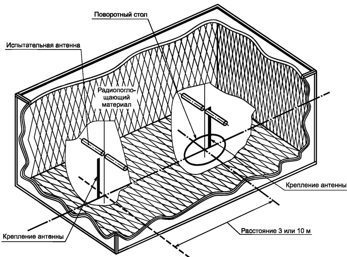
Рисунок А.1 — Типичная безэховая камера
