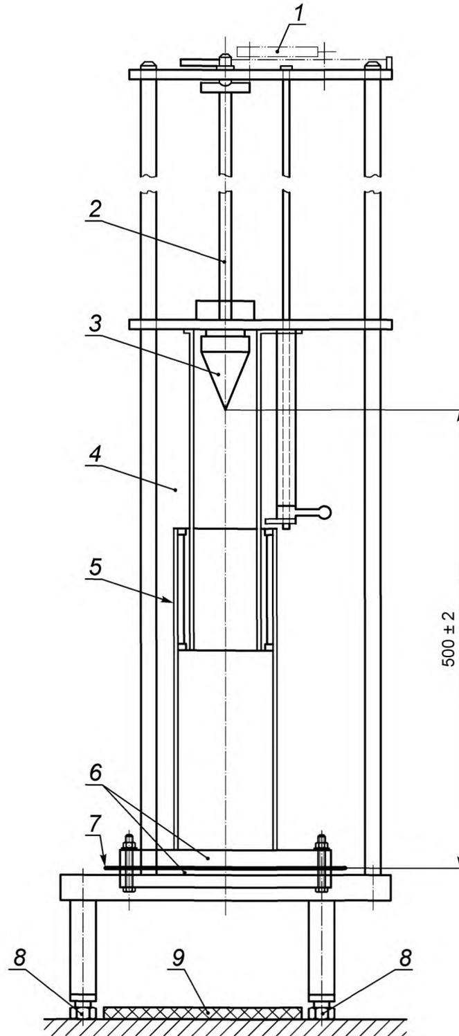
1 — головка с выпускным механизмом для соответствия лабораторным требованиям; 2 — направляющий стержень;
