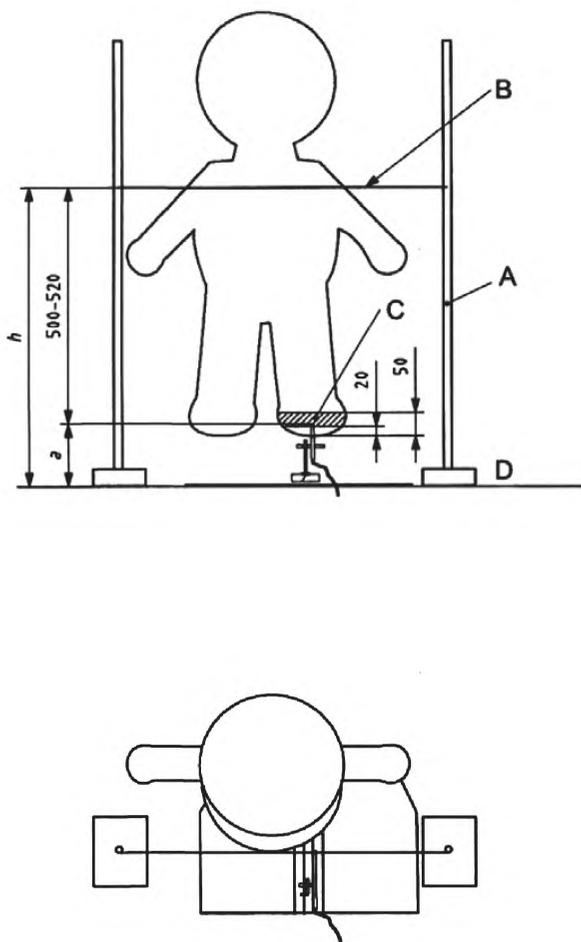
$h$  – высота расположения контрольной нити над рабочей поверхностью;  $a$  – высота над рабочей поверхностью, на которую подносится пламя;  $A$  – вертикальная металлическая подпорка;  $B$  – контрольная нить;  $C$  – зона соприкосновения с пламенем;  $D$  – испытательный стенд
