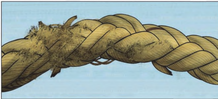
Рисунок С.11 – Механические повреждения
