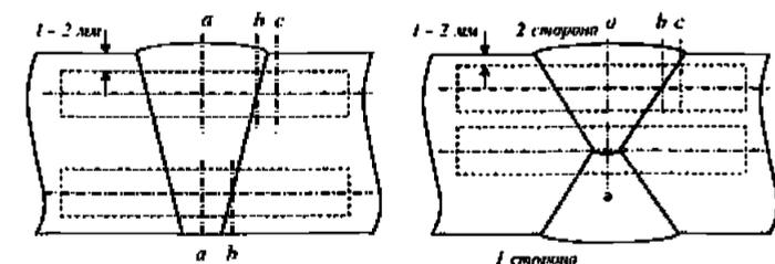
Рис. 6.4.4.4-2 Схема вырезки и расположения надреза на образцах для испытаний на ударный изгиб для технологических процессов сварки с погонной энергией  $\leq 50$  кДж/см:
