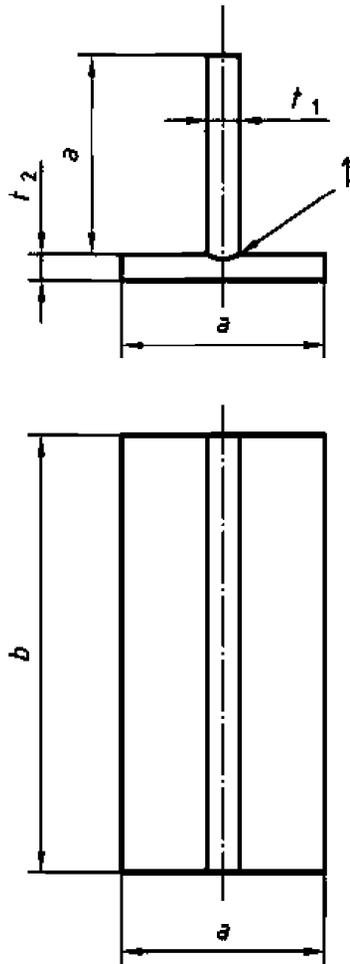
Рис. 8.2.2.6 Проба таврового соединения листов и полуфабрикатов:
