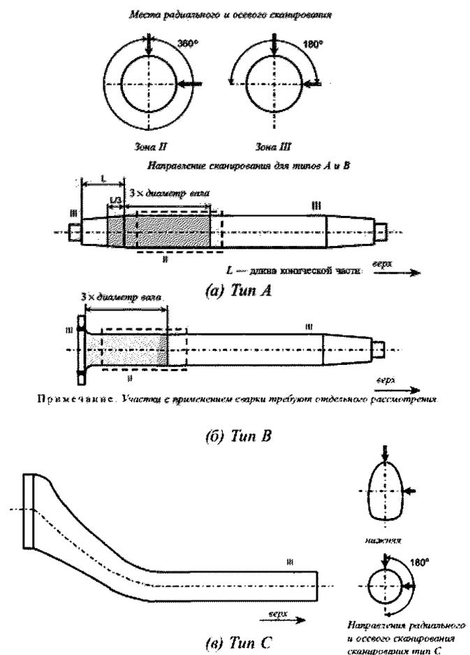
Рис. 2.5.2.4.3.1 Зоны ультразвукового контроля баллера руля
