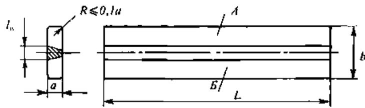
Рис. 6.4.4.2-3 Образец с продольным швом для испытаний на статический изгиб разнородных сварных соединений:
