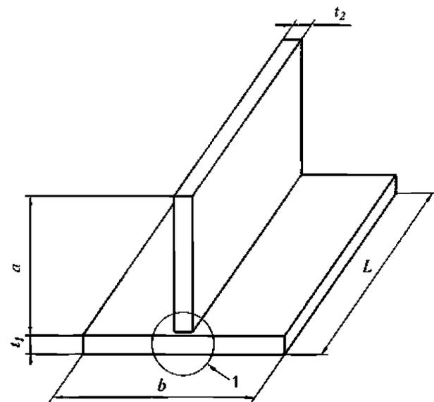
Рис. 6.3.1.5 Проба таврового соединения листов с полным проваром:
