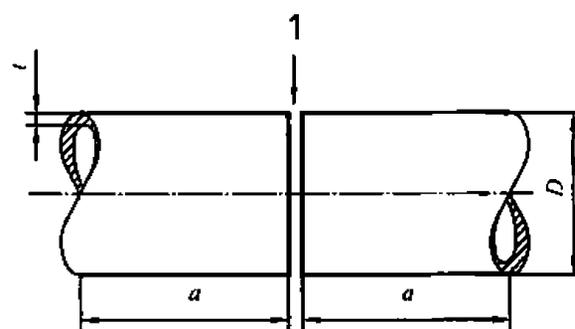
Рис. 6.3.1.3 Проба стыкового сварного соединения труб:
