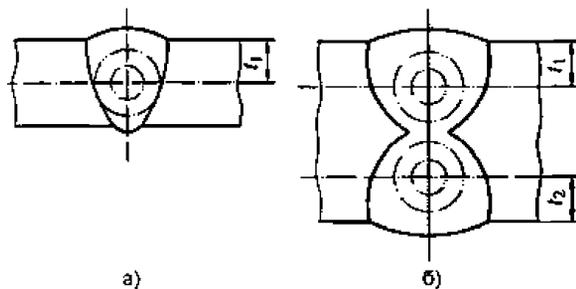
Рис. 6.4.4.1-5 Схема вырезки продольных цилиндрических образцов на растяжение:
