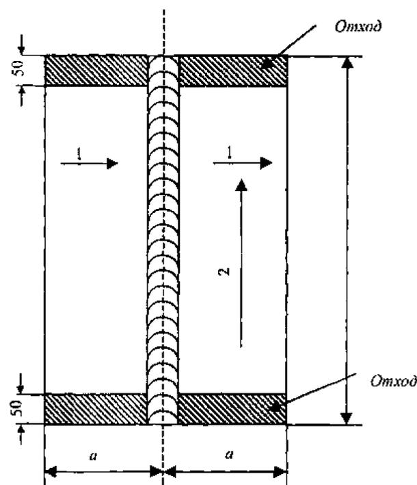
Рис. 6.3.1.2 Проба стыкового сварного соединения листов:
