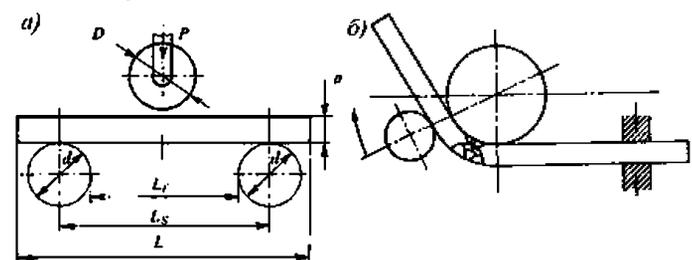
Рис. 6.4.4.2-2 Схема проведения испытаний образцов на статический изгиб:
