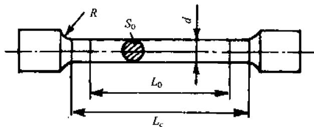
Рис. 6.4.4.1-4 Продольный цилиндрический образец на растяжение металла шва:
