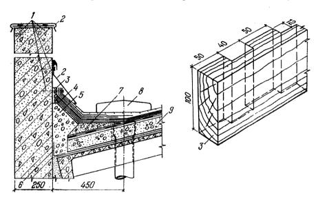
Рис. 4. Примыкание комплексной плиты к парапету продольной стены при привязке колонн «0»
