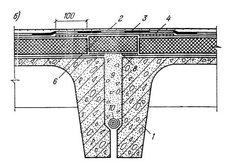
Рис. 3. Продольный стык между комплексными плитами a— при монолитном утеплителе; b— при плитном утеплителе; b— при плитном утеплителе; b— несущая железобетонная плита; b— защитный слой; b— основной водоизоляционный ковер; b— дополнительный слой водоизоляционного ковра; b— цементно-песчаная стяжка; b— пенопластовый вкладыш; b— керамзитовая засыпка; b— паронзоляция стыка; b— бетон марки 150; b0— пороизол, просмоленная пакля
