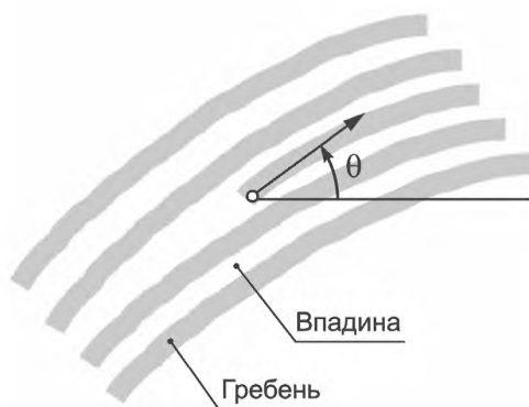
Рисунок 4 — Расположение контрольной точки окончания остова гребня
