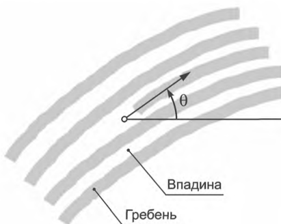
Рисунок 2 — Расположение и направление контрольной точки окончания гребня (закодированной в качестве точки бифуркации остова впадины)
