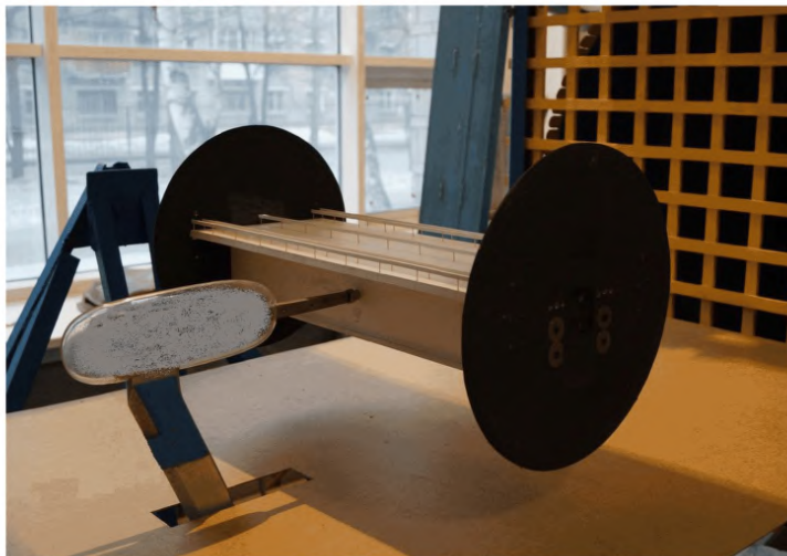
Рисунок Г.2 – Весовые испытания модели в турбулизированном потоке над экраном
