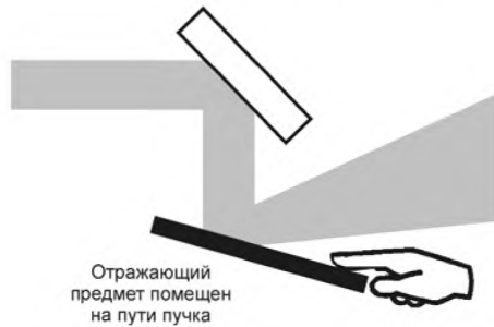
Рисунок В.4d — Отражающий предмет пересекает пучок лазера
