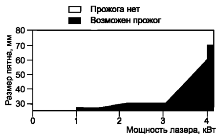
Рисунок F.13 — Стойкость к разрушению листа оцинкованной стали толщиной 1 мм от 10 с экспозиции расфокусированного пучка во время экспериментов с использованием непрерывного лазера на иттрий-алюминиевом гранате с неодимом
