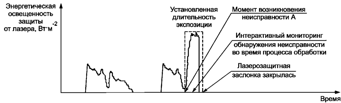
Рисунок В.6а — Отключение лазера при использовании интерактивного машинного мониторинга безопасности
