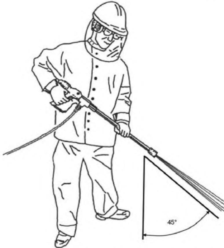
Рисунок DD.5 – Рабочие условия. Положение распыляющего устройства
