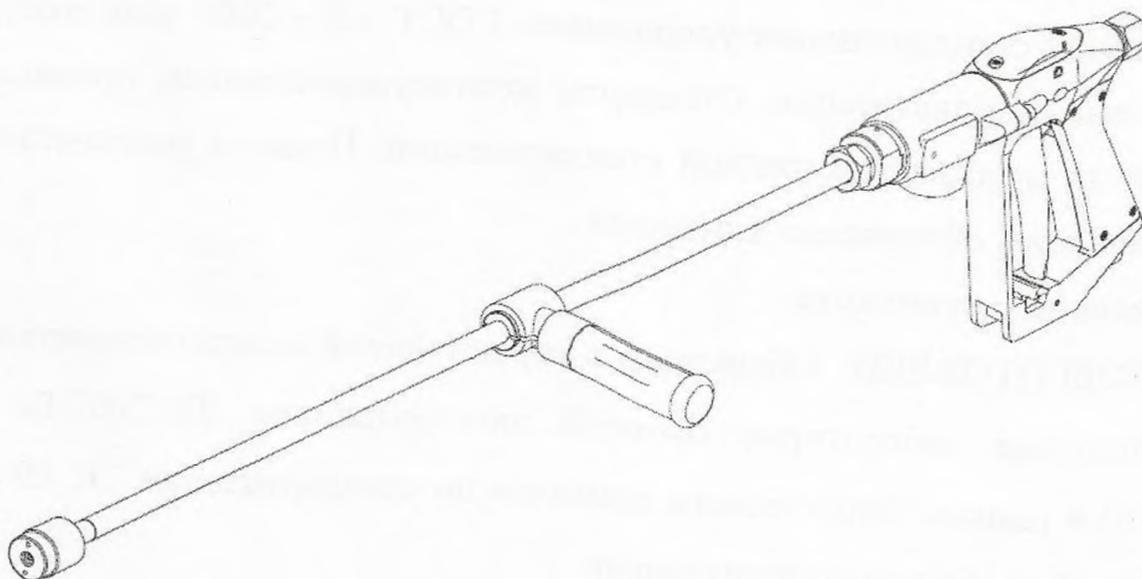
Рисунок DD.2 – Пистолет-распылитель с дополнительной боковой рукояткой
