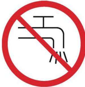
Рисунок 104 – Предупреждающий знак. Машина не пригодна для присоединения к водопроводу
