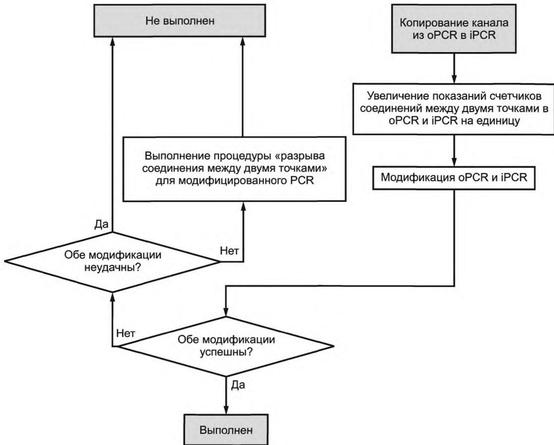
Рисунок 17 — Замена (наложение) соединения между двумя точками
