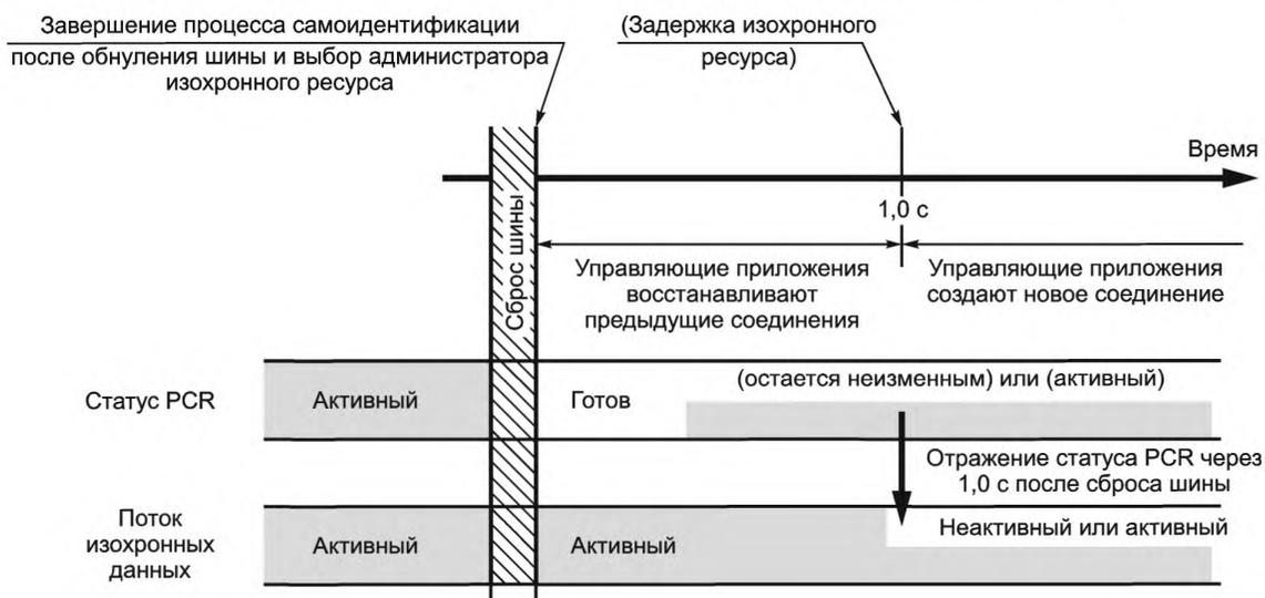
Рисунок 25 — Временная диаграмма управления соединениями и работа PCR
