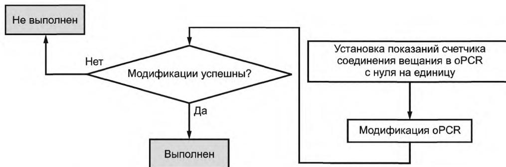
Рисунок 20 — Замена (наложение) соединения выхода из вещания
