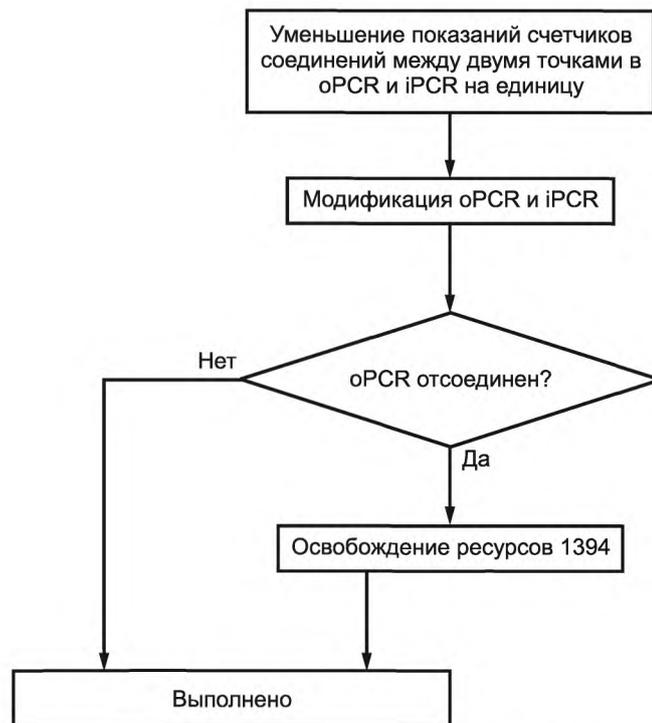
Рисунок 18 — Прерывание соединения между двумя точками
