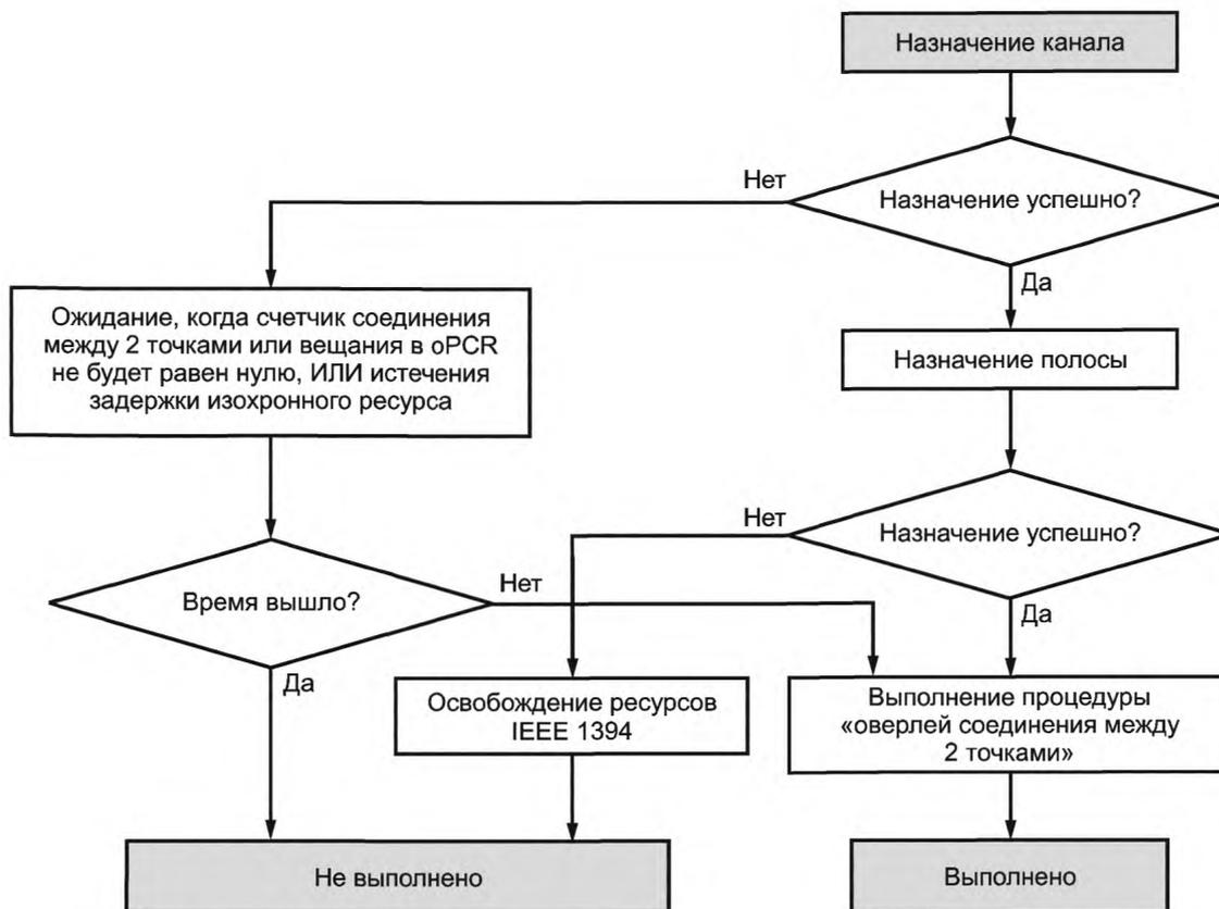
Рисунок 26 — Восстановление соединения между двумя точками
