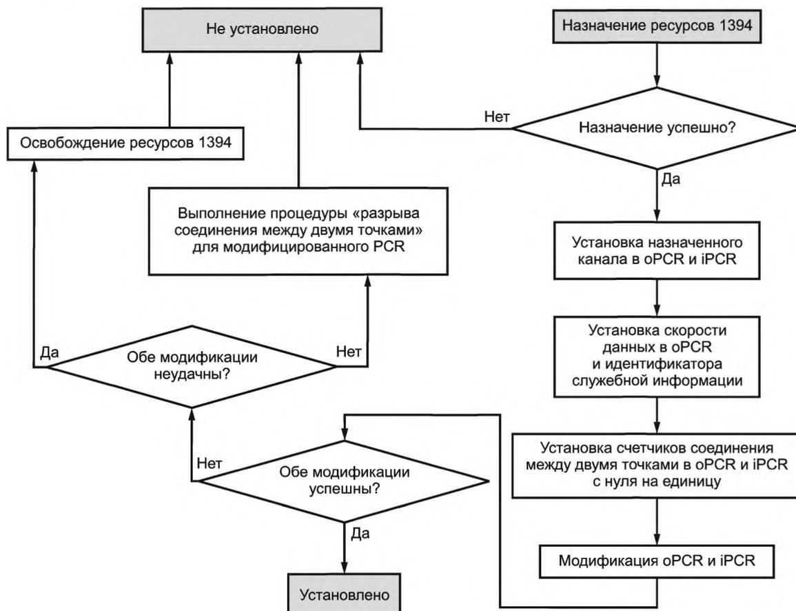
Рисунок 16 — Установка соединения между двумя точками
