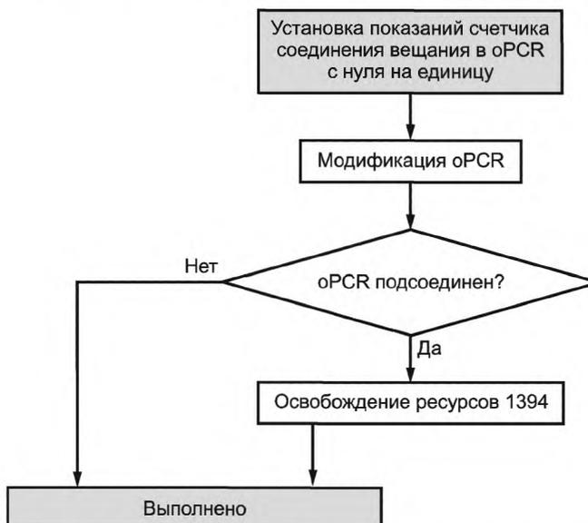
Рисунок 21 — Прерывание соединения выхода из вещания
