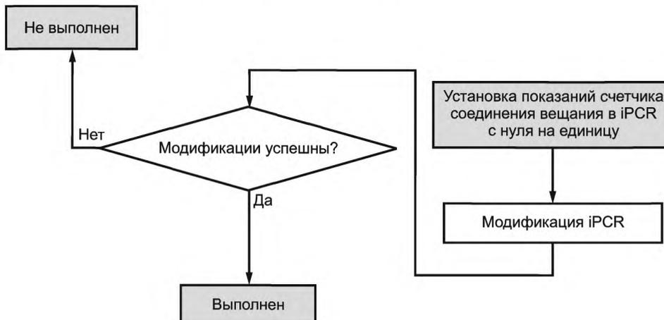
Рисунок 23 — Замена (наложение) соединения входа в вещание
