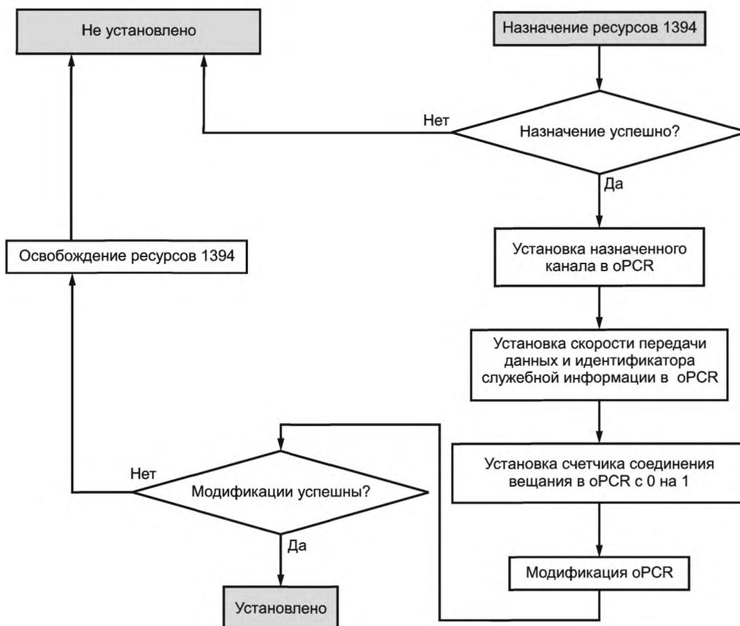
Рисунок 19 — Установка соединения выхода из вещания
