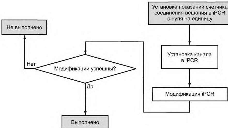
Рисунок 22 — Установка соединения входа в вещание
