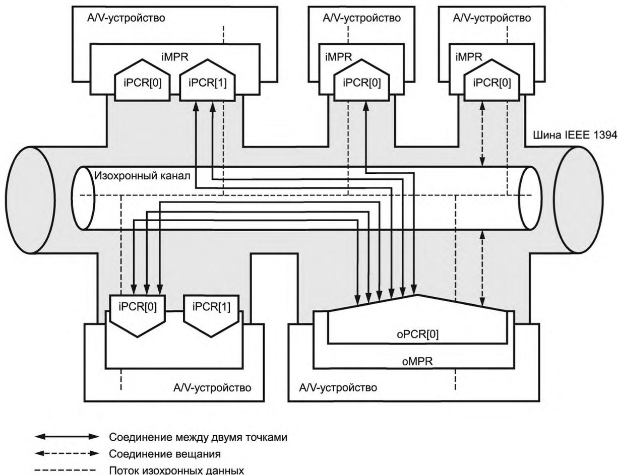
Рисунок 8 — Соединения
