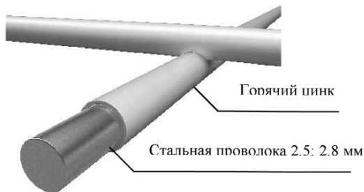
Рис. 1.4 - Противокоррозионное покрытие ССЦП.
