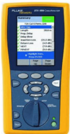
*Рисунок. 8.3.1.1. Внешний вид кабельного сканера Fluke DTX 1800 .*
