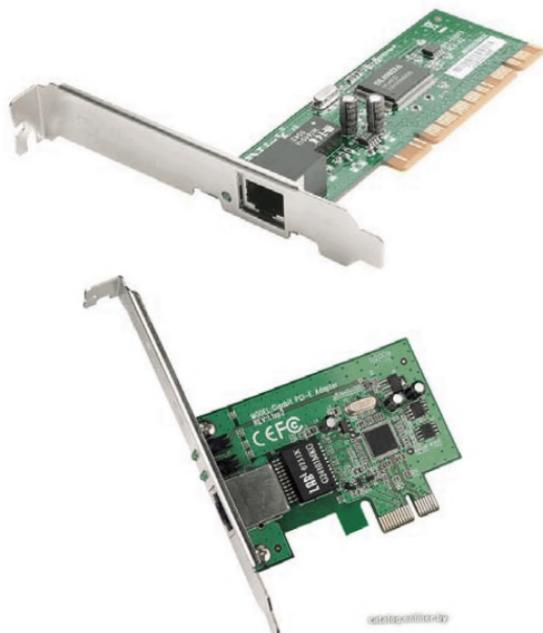
*Рис. 5.1.1.1. Платы сетевых адаптеров PCI и PCI-E.*
