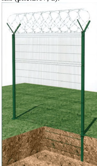
б) Заглубление сварной сетчатой панели
