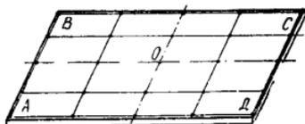
Рис. 3. Схема разбивки поверхности поддона для нивелирования
