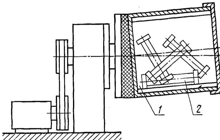
1 — вращающаяся камера; 2 — резиновые трубки с торцевыми кольцами
