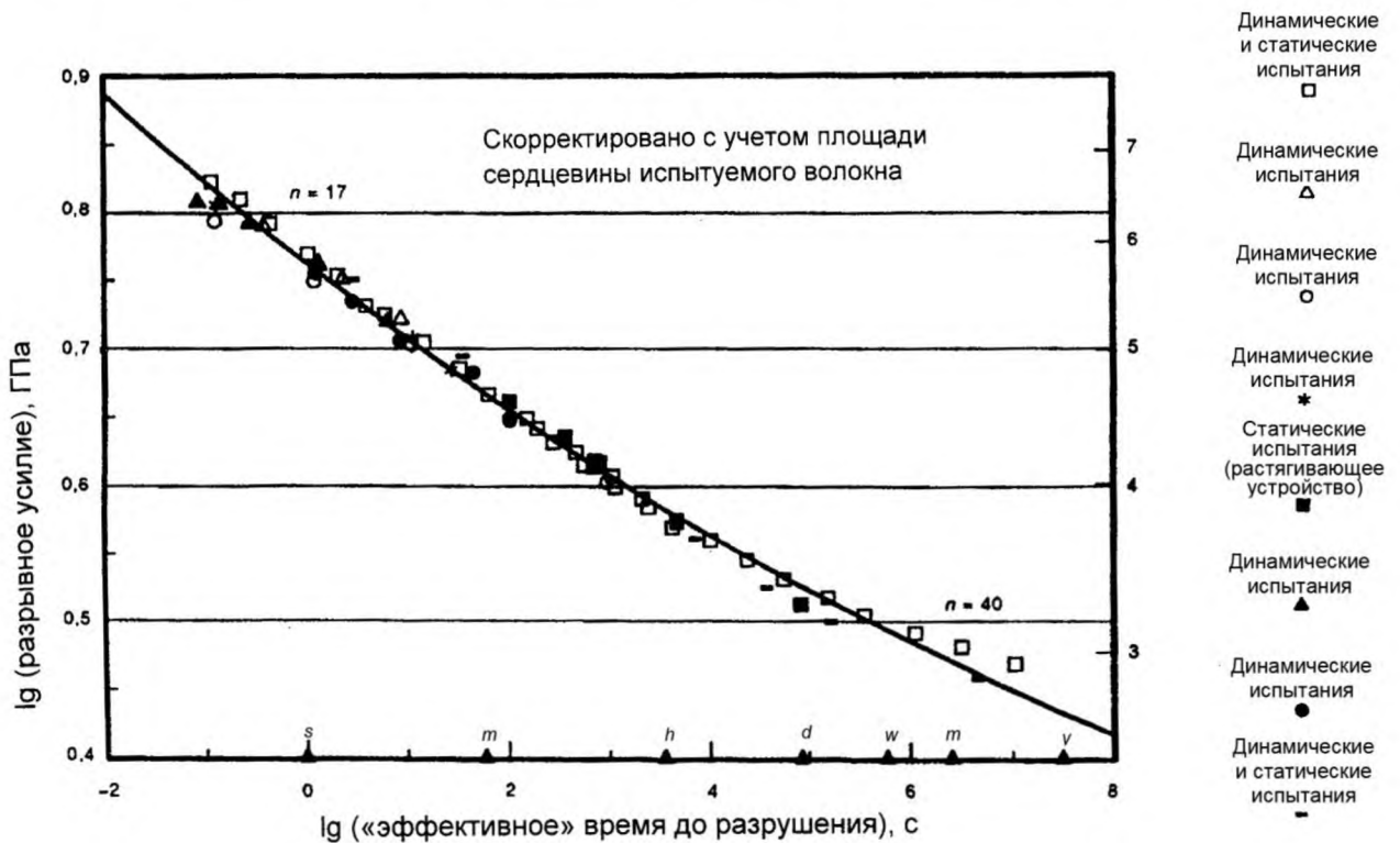
Рисунок Н.2 – Результирующие графики зависимости предела прочности при разрыве от времени при проведении испытаний по круговой системе
