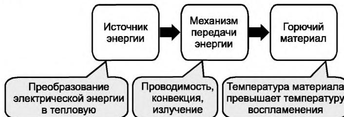
Рисунок 5 — Модель возникновения возгорания при воздействии электричества
