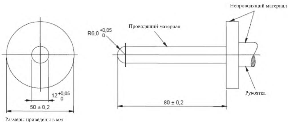
**П р и м е ч а н и е** — Данный испытательный щуп соответствует испытательному щупу рисунка 2с, IEC 60950-1:2005.
