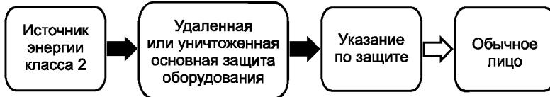
Рисунок 11 — Модель защиты обычного лица от воздействия источника энергии класса 2 в процессе эксплуатации оборудования
