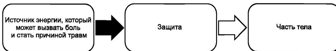
Рисунок 2 — Трехблочная модель защиты
