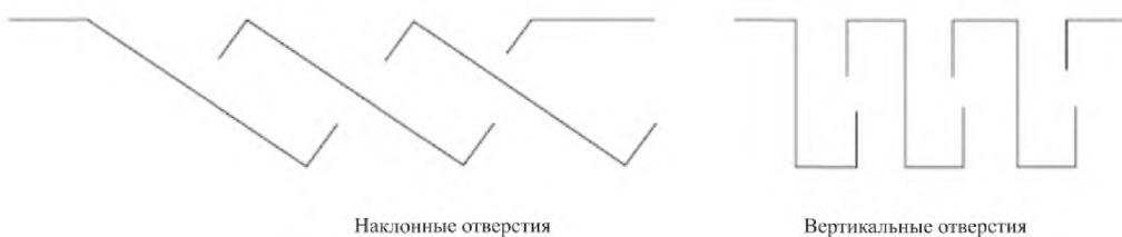
Рисунок Р.1 — Примеры поперечного сечения отверстий, конструкция которых предотвращает попадание вертикально падающих предметов внутрь оборудования
