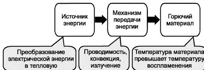
Рисунок 5 — Модель возникновения возгорания при воздействии электричества
