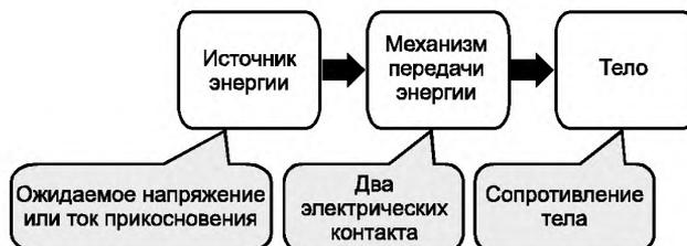
Рисунок 3 — Схема и модель, объясняющая причины возникновения боли и получения травм при воздействии электричества
