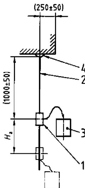
1 – устройство позиционирования на канатах; 2 – анкерный канат; 3 – жесткая стальная масса;
