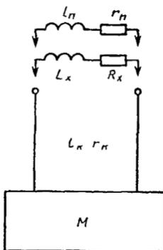
Измерения проводят на установках типов УМИЕ-1, РМ505. Первое уравнивание моста проводят подключив поверяемую катушку с индуктивностью  $L_x$  и активным сопротивлением  $R_x$  к измерительной установке соединительными проводниками с индуктивностью  $l_n$  и активным сопротивлением  $r_n$ .
