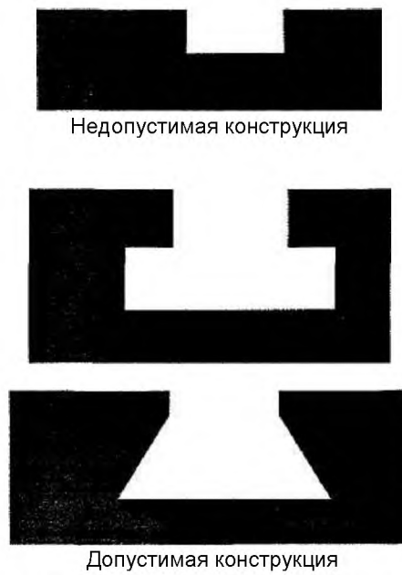
Рисунок М.306 – Примеры геометрии паза для размещения линейки в щелях поперечной распиловки на столах для пил
