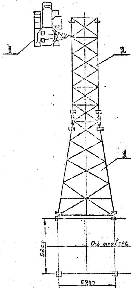
Рис.31 Сборка нижней плоскости 1<sup>ой</sup> и 2<sup>ой</sup> секции опоры 4220-1
