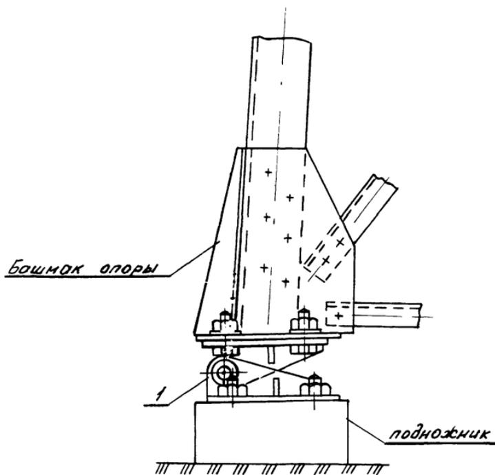
Рис. 9 Закрепление монтажного шарнира
