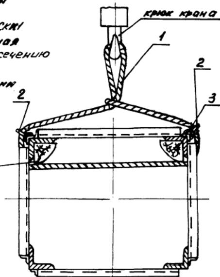
Рис. 6 Узел II Стреловка опоры
