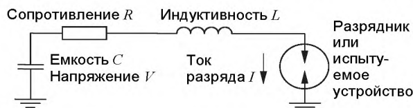
Рисунок 5 – Принципиальная схема устройства для моделирования разрядов статического электричества
