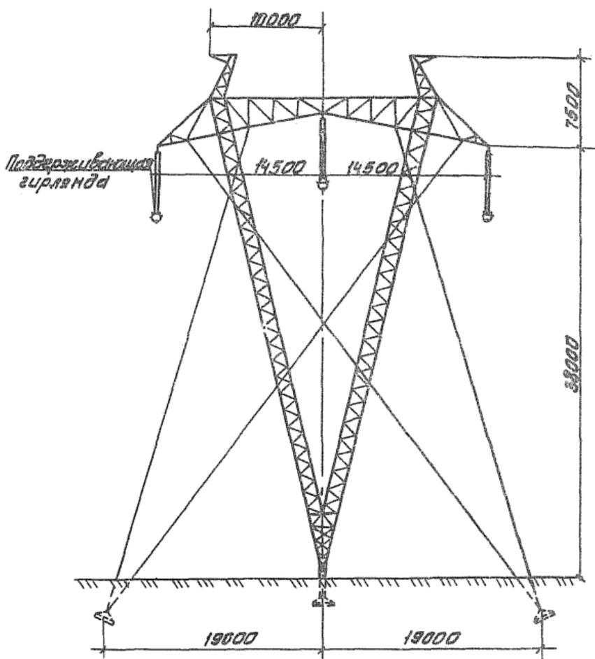
Рис.0-4. Промежуточная опора на оттяжках
