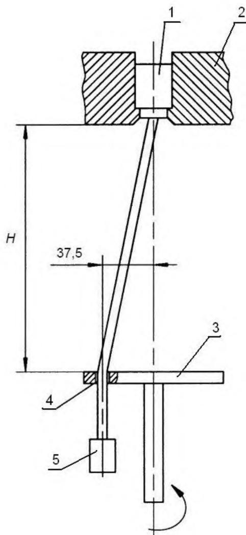
1 — испытуемое устройство УСС; 2 — крепление; 3 — плата; 4 — втулка; 5 — груз
