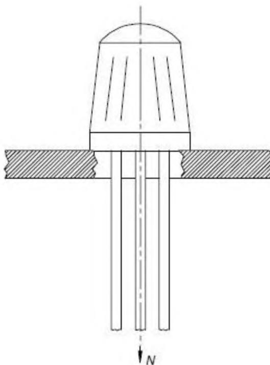
Рисунок 103 – Пример приложения тянущего усилия вдоль оси УСС
