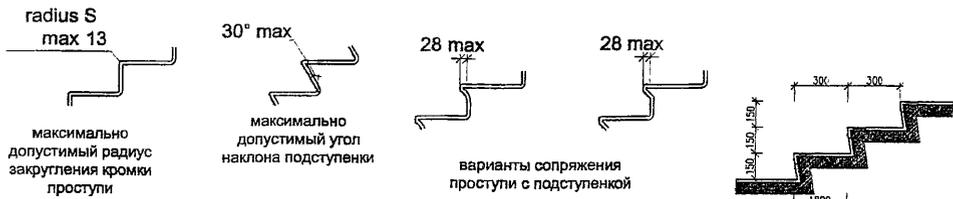
Рисунок 7.26 – Варианты сопряжения подступенки - проступи и габариты ступеней
