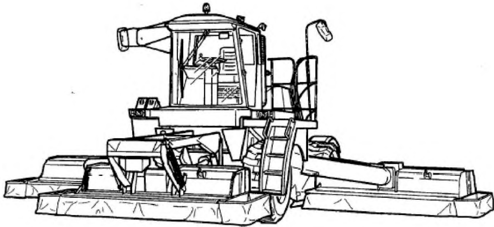
Рисунок С.3 — Самоходная ротационная косилка
