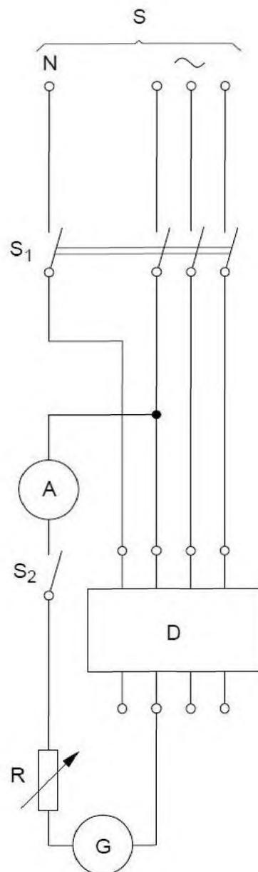
*S* — источник питания; *S*<sub>1</sub> — испытательный выключатель, коммутирующий все полюса;
