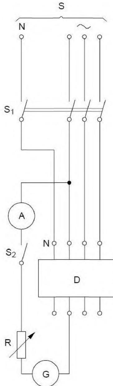
*S* — источник питания; *S*<sub>1</sub> — испытательный выключатель, коммутирующий все полюса;
