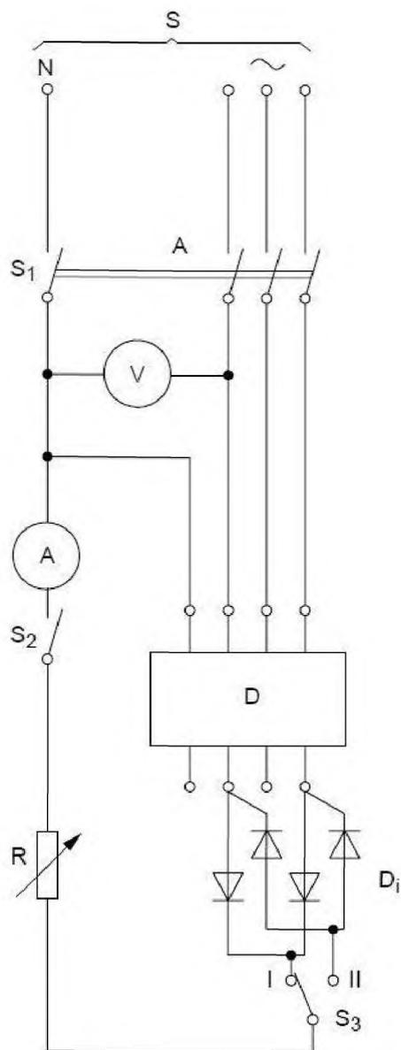
S — источник питания; S<sub>1</sub> — испытательный выключатель, коммутирующий все полюса;
