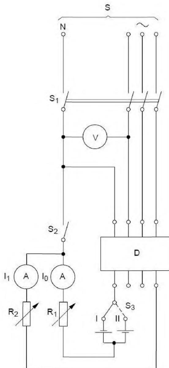
$S$  — источник питания;  $S_1$  — испытательный выключатель, коммутирующий все полюса;
