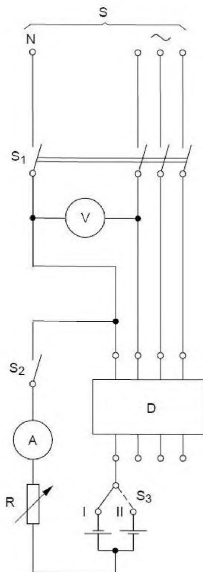
S — источник питания; S<sub>1</sub> — испытательный выключатель, коммутирующий все полюса;
