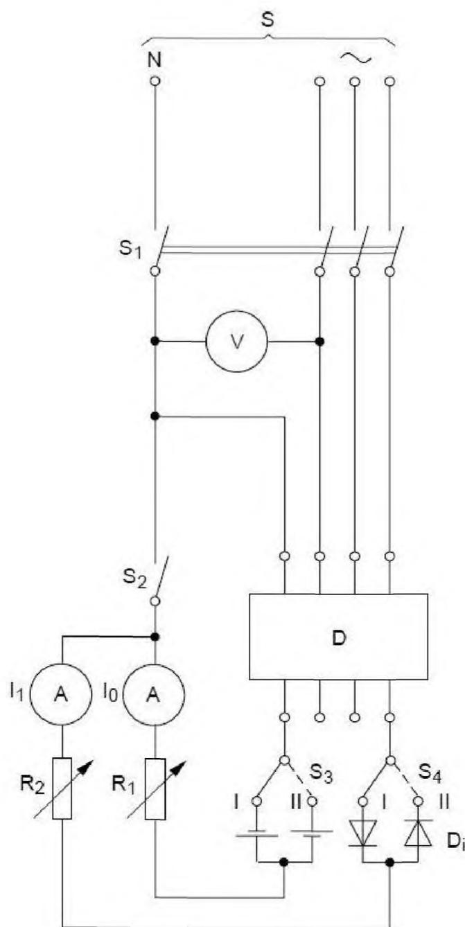
$S$  — источник питания;  $S_1$  — испытательный выключатель, коммутирующий все полюса;
