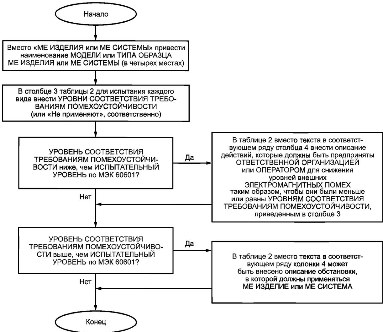
Рисунок 3 — Порядок заполнения таблицы 2 [см. 5.2.2.1 f)]
