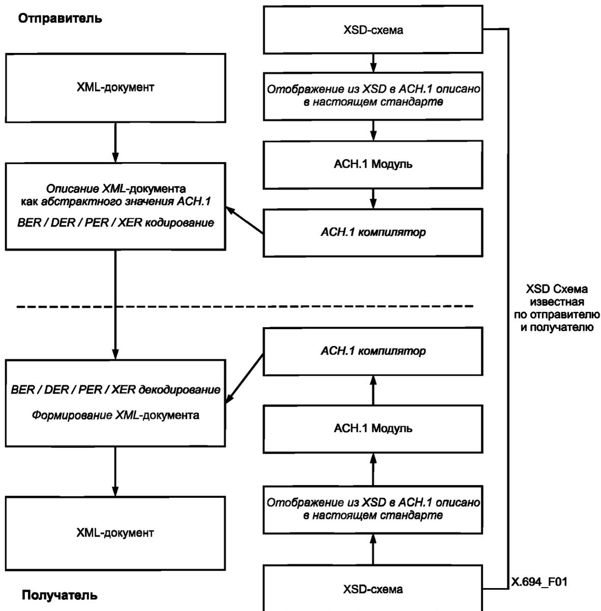
Рисунок D.1 — Передача документа XML с применением отображения XSD в ASN.1
