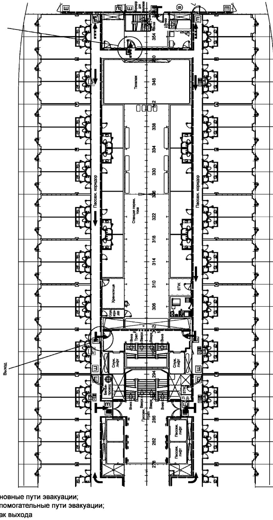
Рисунок G.6 — Пример, поясняющий 6.2.2. Полосы НРО расположены только на стороне коридора, где находится дверь выхода
