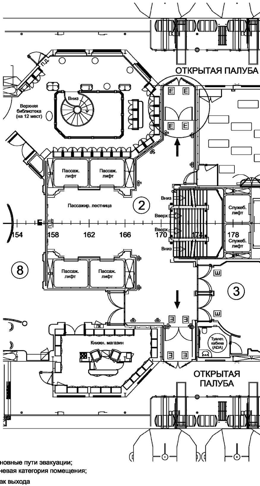
Рисунок G.8 — Пример, поясняющий 6.5.5. Расположение двух знаков выхода на двухстворчатых дверях, ведущих на открытую палубу
