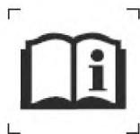
Рисунок 2 — Символ в соответствии с ИСО 7000-1641, обозначающий информационную пиктограмму (Руководство по эксплуатации)
