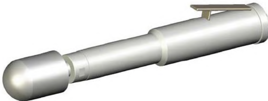
Рисунок 2 – Прямая шлифовальная машина с шлифовальной головкой типа 18R
