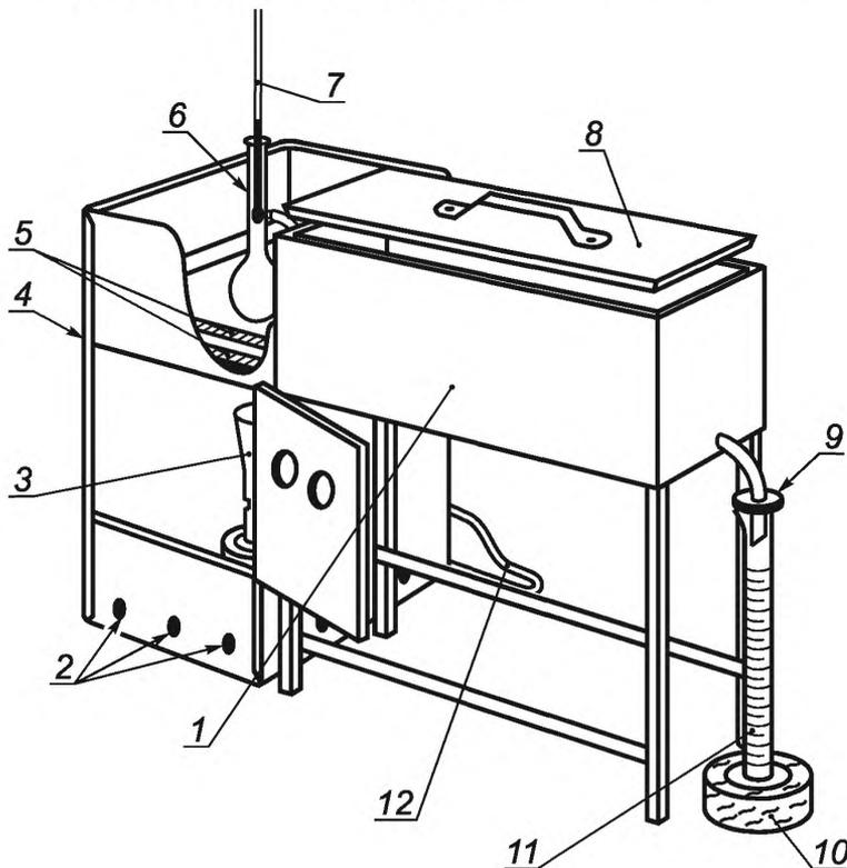
1 — охлаждающая баня; 2 — вентиляционные отверстия; 3 — газовая горелка; 4 — защитный экран; 5 — термостойкие прокладки; 6 — перегонная колба; 7 — термометр; 8 — крышка бани; 9 — фильтровальная бумага; 10 — подставка; 11 — приемный цилиндр; 12 — газопровод
