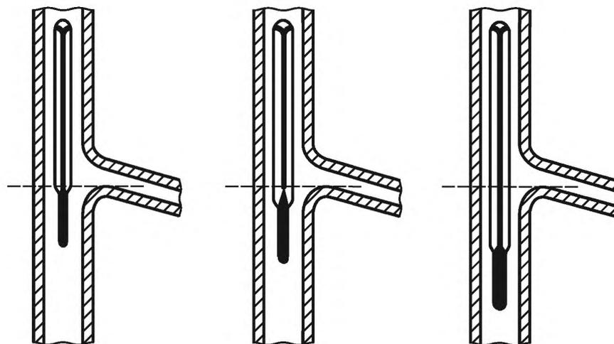
Рисунок 8 — Положение термометра в колбе для разгонки
