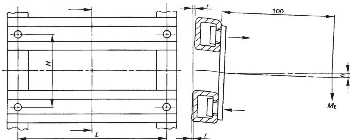
Рисунок В.6 – Конструкция из двух одинаковых направляющих С-образного профиля.
