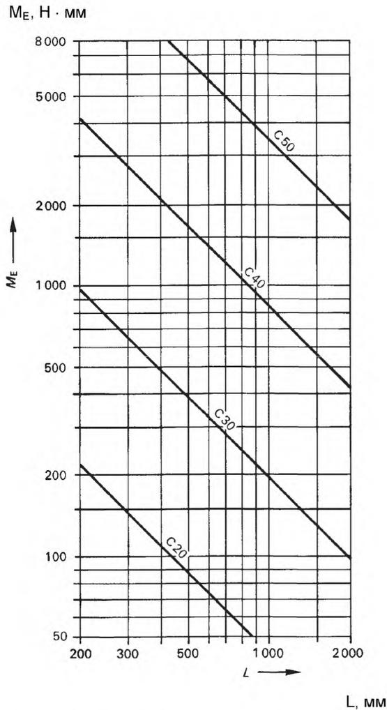
Рисунок В.5 – Допустимая нагрузка  $M_E = f(L)$
