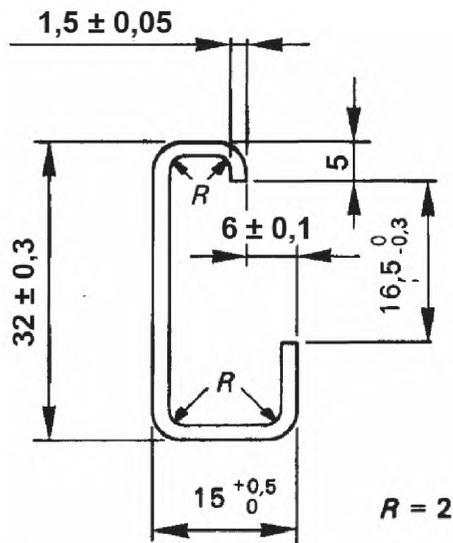
Рисунок А.9 – Размеры направляющих G-образного профиля
