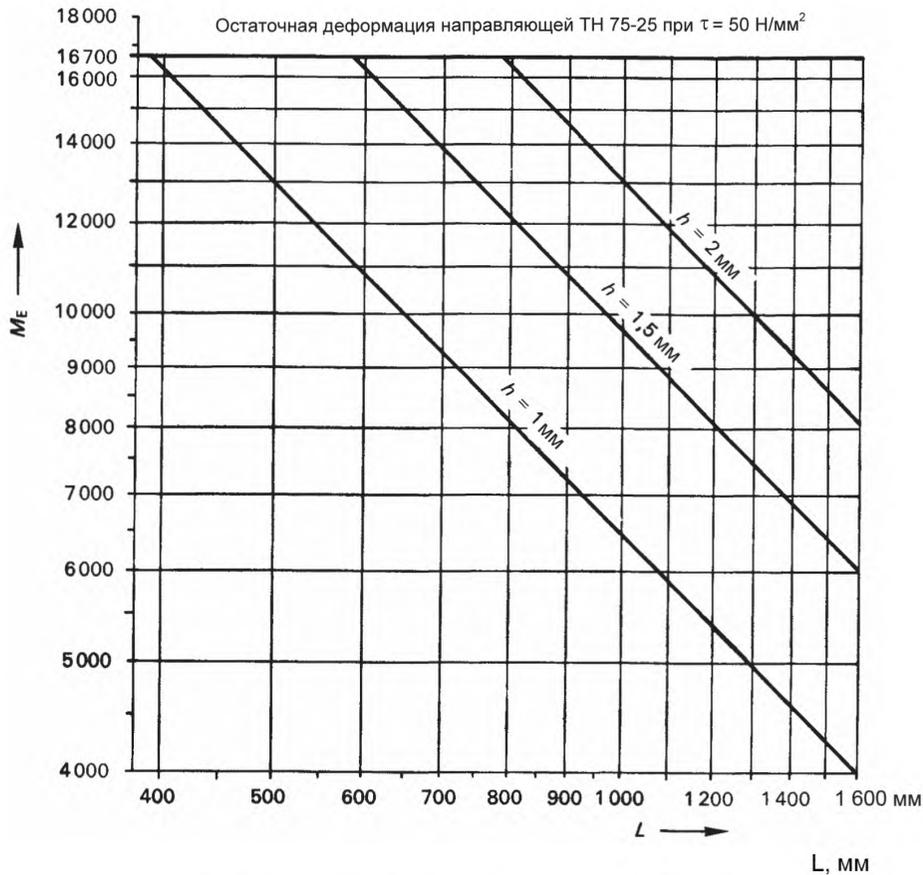
Рисунок В.3 – Допустимая нагрузка  $M_E = f(L, h)$
