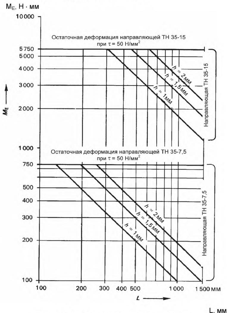
Рисунок В.2 – Допустимая нагрузка  $M_E = f(L, h)$ **Примеры**
