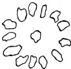
Рисунок 2 – Типичная форма факела распыла
