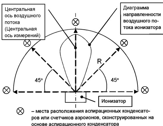
Рисунок 1 — Схема измерений полярной объемной плотности электрического заряда ионизированного воздуха (счётной концентрации аэроионов) с использованием метода аспирационного конденсатора
