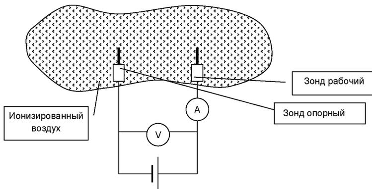
Рисунок 2 — Схема установки
