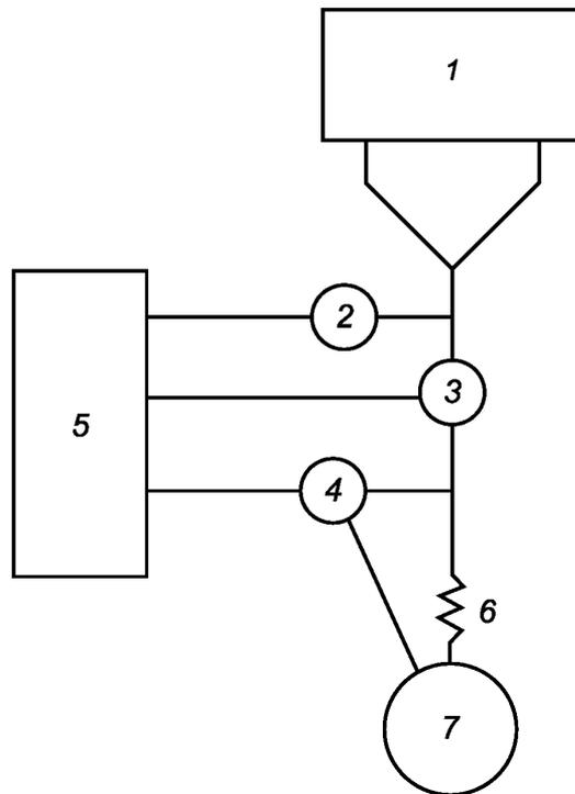
1 — испытуемый АППАРАТ ИСКУССТВЕННОЙ ВЕНТИЛЯЦИИ ЛЕГКИХ; 2 — датчик давления; 3 — датчик потока;
