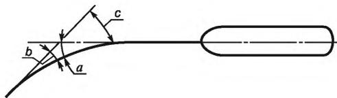
Рисунок D.2 — Определение угла остаточной деформации
